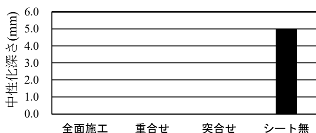
図-7 中性化深さの測定結果
