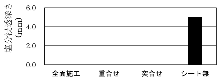
図-3 塩化物イオン浸透深さの測定結果（半年暴露）
